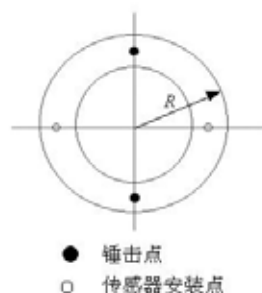
图 9.3.3 - 2 管桩传感器安装点、锤击点布置示意图
